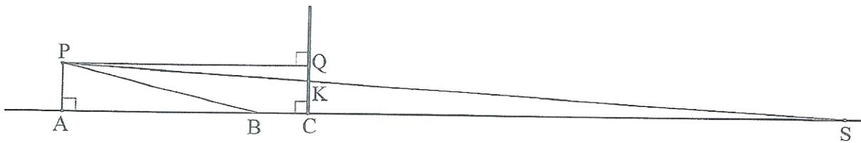
Pour que l'éclairage d'une voiture soit conforme, les constructeurs déterminent l'inclinaison du faisceau. Cette inclinaison correspond au rapport  $\frac{QK}{QP}$ . Elle est correcte si ce rapport est compris entre 0,01 et 0,015.
