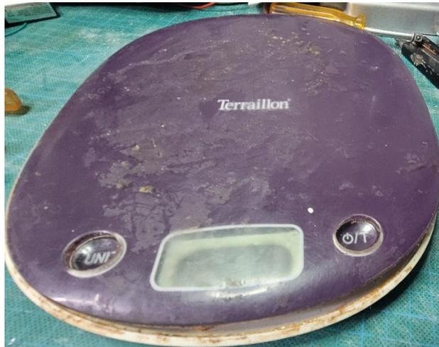
**Démontage :** **Enlever les piles.** Après avoir dévissé les vis du dessous, couper les adhésifs entre la plaque violette et le reste de la balance avec une lame de cutter. Leur situation est visible sur la photo 2 (vue de dessous) qui vous permettra de vous repérer
